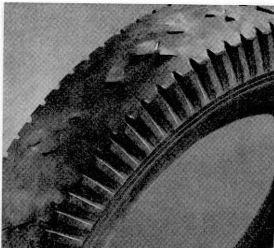
Der Reifen mit zu geringem Luftdruck trägt nur mit seinen Schultern, die dadurch einem stärkeren Verschleiß als die Profilmittle unterliegen.
