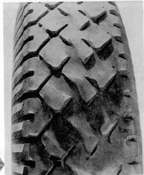
Diese Schäden werden durch eine stufenförmige Abnutzung über die ganze Lauffläche — auch schuppen- und sägezahnähnlich — sichtbar.
