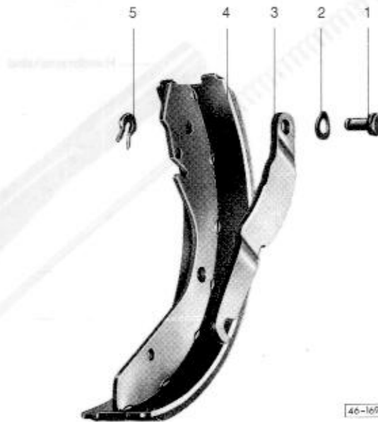
Abb. 7 Bremshebel lagerrichtig mit neuem Lagerbolzen befestigen
