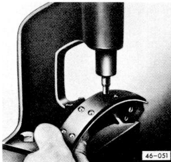
Abb. 6 Neue Beläge von der Mitte aus aufnieten
