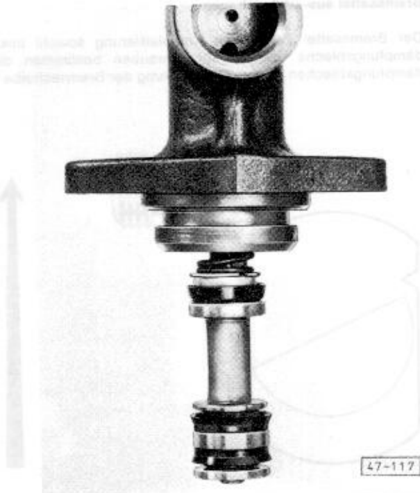
Abb. 4 Einbau des Zwischenkolbens Hauptbremszylindergehäuse mit der Öffnung nach unten halten.
