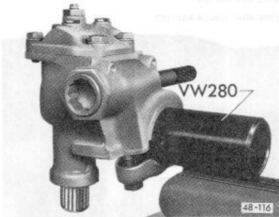
Abb. 2 Lenkgetriebe auf die Montage- und Prüfvorrichtung VW 280 aufschrauben
