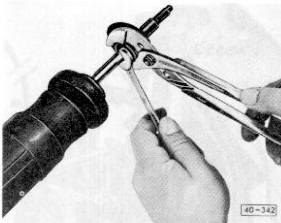
Abb. 29 Anschlaggummi ersetzen Dazu Anschlagbolzen abschrauben.
