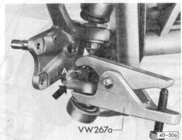
Abb. 5 Achsschenkel abdrücken, unteres Gelenk Hutmutter (A) bis Anschlag aufschrauben (nur leicht gegenziehen), gegebenenfalls bei gespannter Vorrichtung einige Preßschläge gegen das Auge des Achsschenkels (Pfeil).
