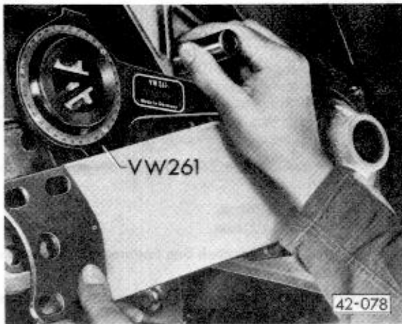
Abb. 5 Einstellwinkel für Federstab messen
