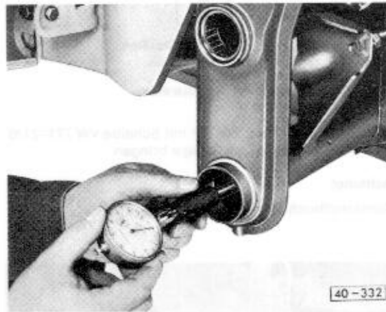
Abb. 19 Verschleiß der Metallbuchse prüfen (innere Traghebellagerstelle)
