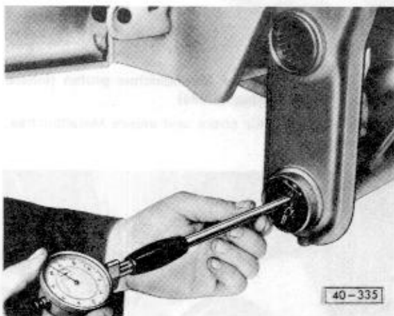
Abb. 22 Nadellagersitze auf Verschleiß prüfen Es gibt Nadellager in Normal- und Übergröße:
