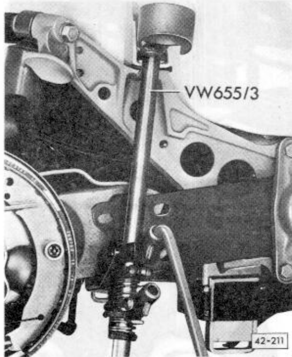
Abb. 5 Federstrebe anheben Vorrichtung am Ende der Strebe ansetzen.
