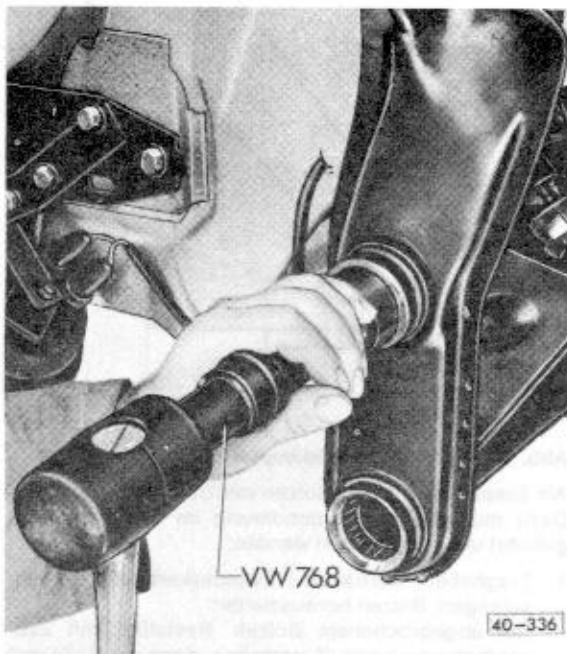
Abb. 23 Metallbuchse oben und Nadellager oben einbauen
