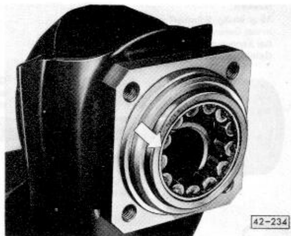
Abb. 12 Zylinderrollenlager, Außenlaufing einsetzen (z. B. mit VW 415a) Bördeleante nach außen (Pfeil). AUDI NSU: Einpreßteller 30-504, Einsteckdorn 30-505
