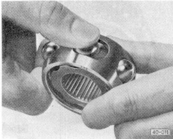
Abb. 8 Kugeln in den Käfig drücken
