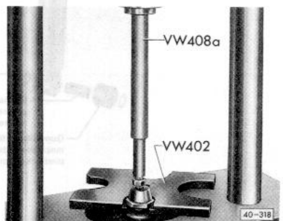
Abb. 5 Exzenterbuchse abpressen (Mutter aufschrauben).
