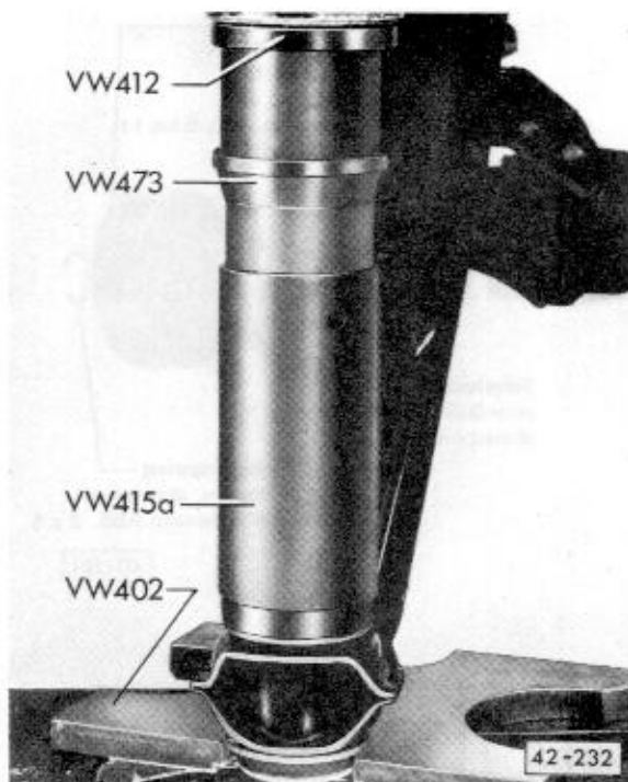
Abb. 10 Gummimetalllager (zweites Lager) einpressen AUDI NSU: Einsteckdorn 30-505, Einpreßteller 30-504, Untersatz 40-103, VW 402
