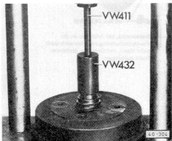
Abb. 3 Außenlauftring für äußeres Radlager einpressen AUDI NSU: Einpreßwerkzeug 40-503, Einsteckdorn 30-505
