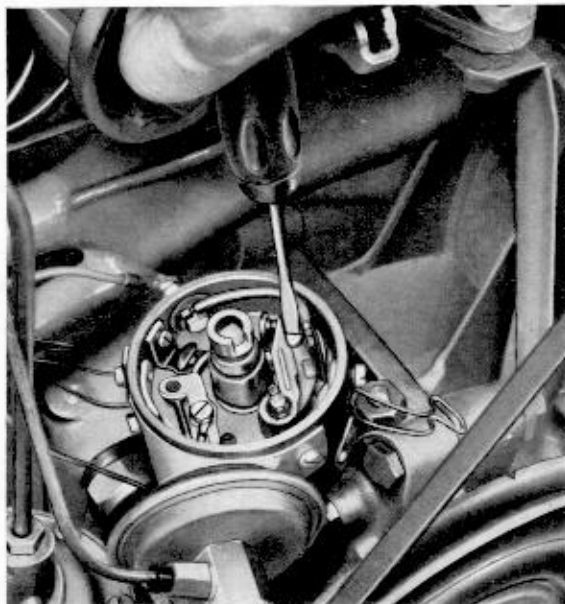
4 - Kontaktabstand durch Verdrehen der Stellschraube mit einer Fühlerlehre auf 0,4 mm einstellen.
