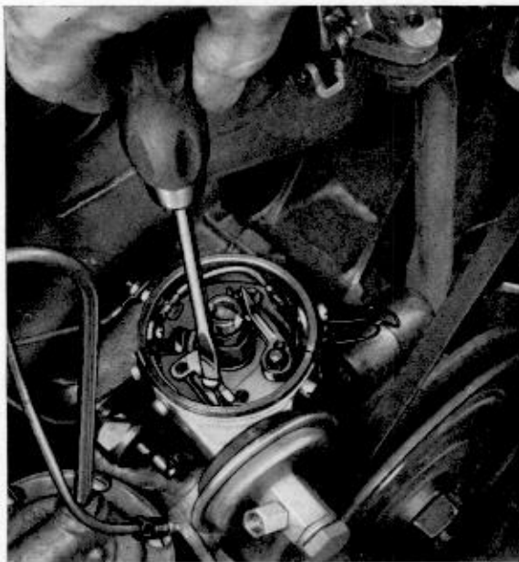
4 - Zwei Befestigungsschrauben des Unterdruckverstellers abschrauben.
